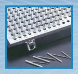
针规:用于检查位置,测量孔的尺寸,检查两 孔距,也可作通止规及测量孔的深度用, 是孔的标准化检测的必备检具,用国际 先进的激光检测仪检测工件。并广泛用 于电子板、线路板、模具、精密机械制 造等各种高精尖技术领域。
